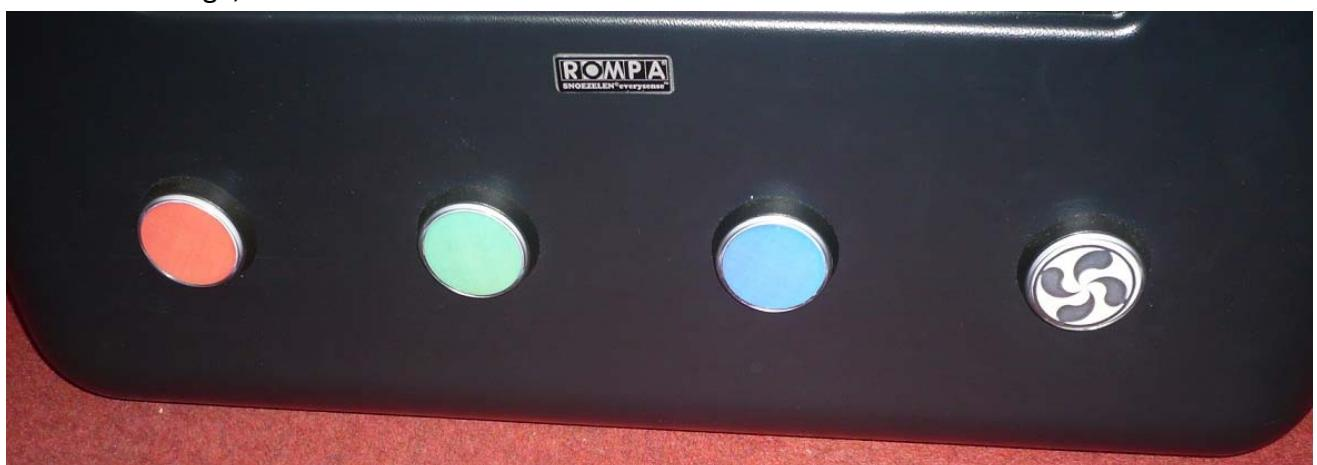
5. Le bouton à la droite vous permet de contrôler l'intensité du ventilateur. Il y a trois réglages. Avec chaque appui sur ce bouton, l'intensité devient plus forte.
