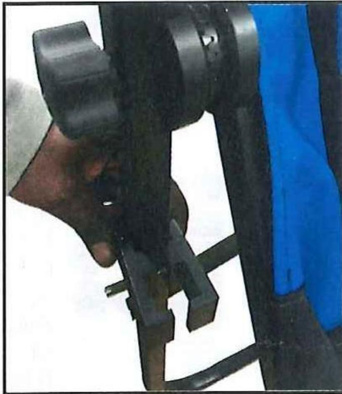
7. Faites passer le côté gauche des parties d'extension pour les Repose-Pieds dans le tube d'attache droit. Faites passer le boulon à travers le trou à droite à l'intérieur du tube droit et le faites passer vers le trou à l'extérieur.
