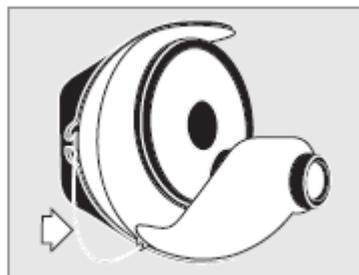
3. Installez la Roue fournie. La roue a une attache magnétique. Positionnez la diapositive à la gauche de l'adaptateur magnétique (selon l'image). Positionnez la roue magnétique sur l'adaptateur magnétique du projecteur. Pour enlever la roue, tirez-le.
