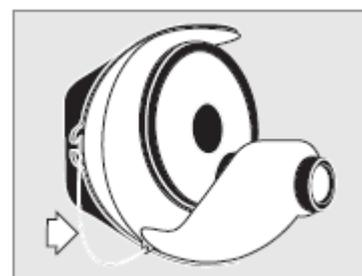
3. Installeer het meegeleverde effectwiel. Dit werkt met een magneet - de schuif aan de linkerkant van de magneetadapter moet bovenaan zitten, zoals getoond op de afbeelding. Plaats het magnetische wiel op de magnetische adapter op de projector. Om het wiel te verwijderen, kunt u het wiel optillen.
