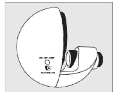
9. Om de afbeelding te dimmen, moet u de knop "DIM – OFF – TIMER" in drukken en vasthouden tot de lichtopbrengst het gewenste niveau bereikt heeft. **Let op:** bij vloeibare effectwielen kan het tot 15 minuten duren voordat ze beginnen te werken. De olie die deze wielen bevat, moet opgewarmd worden. Deze warmte komt van de projector.
