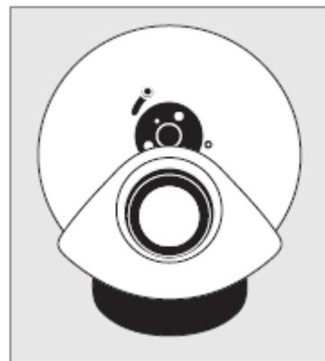
4. Om de standaard Rompa effectwielen te gebruiken met deze projector, moet de magnetische adapter van de projector eerst verwijderd worden. Gebruik hiervoor een kleine inbussleutel en plaats deze in het gat aan de bovenkant van de magnetische adapter. Draai de inbussleutel tegen de klok in om de adapter los te maken van de projector.
