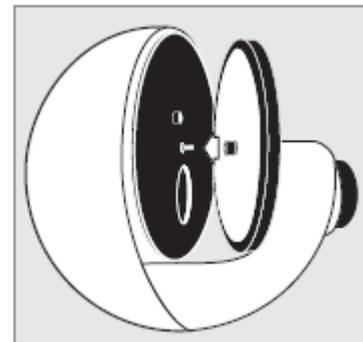
Pour attachez les roues en verre (ex. les Roues Liquides), serrez la petite vis cruciforme sur la hampe de la partie rotative selon l'image.
