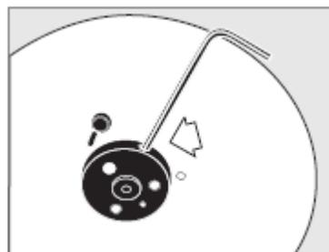
te bevestigen, moet u ervoor zorgen dat de platte kant van de as naar de bovenkant van de projector gericht is. Plaats de magnetische adapter op de as en draai de inbusleutel met de klok mee.
