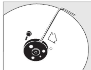
**Prière de noter** : Il peut être nécessaire d'allumer le projecteur pour faire bouger la partie qui tourne la roue. Il est important que le trou au-dessus de l'adaptateur magnétique soit en haut du projecteur.
