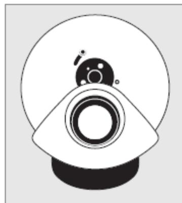
4. Pour utiliser les Roues non-magnétiques de ROMPA® (les roues typiques de ROMPA®) enlevez d'abord l'adaptateur magnétique du projecteur – servez-vous de la petite clé fournie. Mettez un bout de la clé dans le trou au-dessus de l'adaptateur magnétique. Tournez la clé dans le sens inverse des aiguilles d'une montre pour desserrer et puis détacher l'adaptateur du projecteur.
