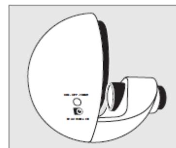
9. Pour réduire l'intensité de l'image, appuyez sur (et tenez) le bouton 'DIM – OFF – TIMER' jusqu'au moment où l'intensité soit correcte. **Prière de noter** : il faut attendre environ 15 minutes pour le bon déplacement de la liquide dans les Roues Liquide (l'huile là-dedans doit se chauffer un peu pour se déplacer fluidement – le projecteur chauffe l'huile pendant l'usage).
